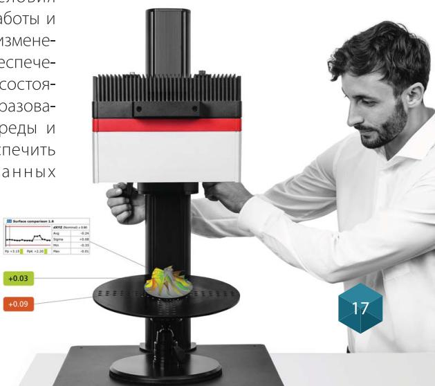
Сенсоры ATOS Capsule™ позволяют получить 3D-координаты поверхности для каждого отдельного измерения. До 12 милли-онов независимых точек с поверхности изделия фиксируется за 1-2 секунды. Получаемые данные характеризуются высоким уровнем детализации, что позволяет получать информацию и измерять даже очень маленькие элементы изделий.
